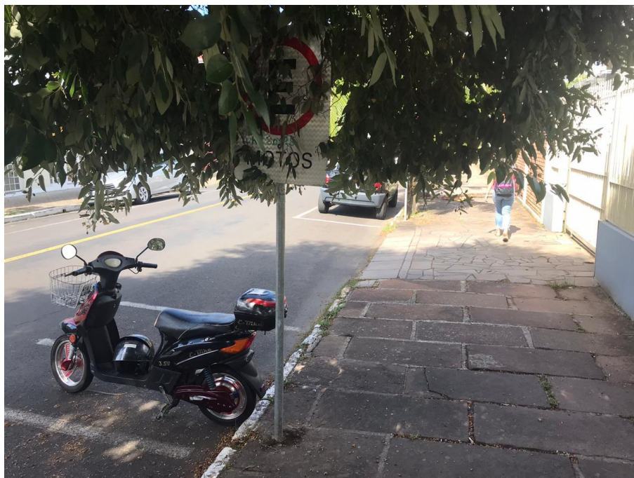
Figura 61 – Copa de árvore comprometendo circulação de pedestres e visão da sinalização.
